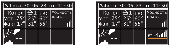
Рис.19 Проверка подключения котла к Вашей сети WiFi
