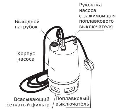
Рис. 1 Конструкция насосов APV.06 / APV.40 V
