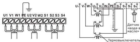
**Рис. 6** Схема подключения для насосов 45,0 – 75,0 кВт. Пуск «звезда-треугольник». Электродвигатель с внешними выводами от термодатчика (клеммы S1, S2) и с внешними выводами от датчика протечки (клеммы S3, S4).
