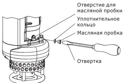
Рис. 9 Отверстие для слива и заливки масла
