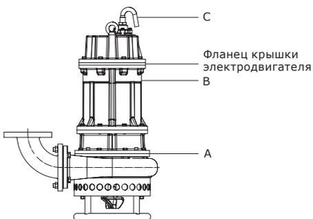
**Рис. 7** Уровни включения, выключения, аварийного выключения (сухого хода)
