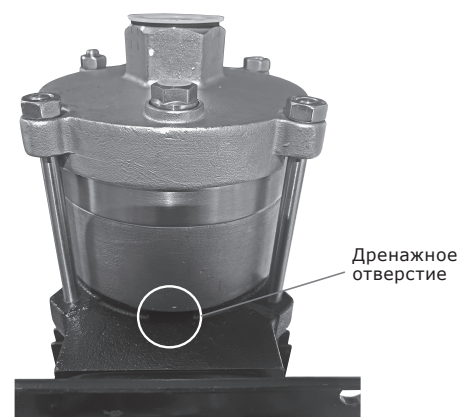
Рис. 11 Дренажное отверстие торцевого уплотнения
