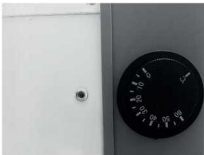
Рисунок 3 - Регулятор температуры лицевой панели конвектора
