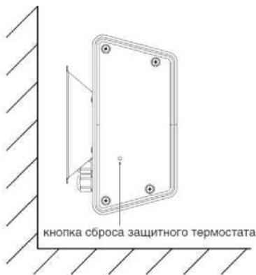
Рисунок 6 - кнопка сброса аварийного термостата
