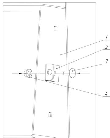
**Рисунок 9 — Установка кронштейна для горелки**
