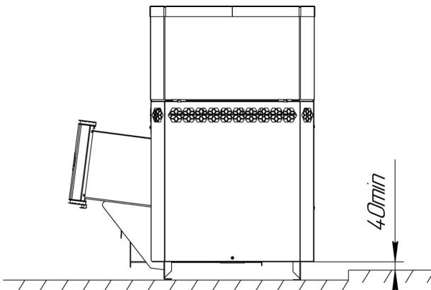
Рисунок 4 — Установка печи ниже уровня чистового пола
