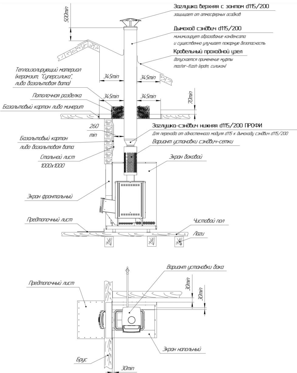
Рисунок 6 - Схема установки печи с защитными экранами
