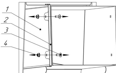
**Рисунок 7 — Снятие кронштейна дверки (базовое расположение)**
