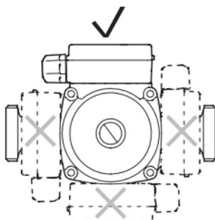
**Рис. 4** Возможное положение клеммной коробки PROMO 15-9A
