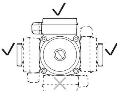
**Рис. 5** Возможное положение клеммной коробки PROMO 15-12A
