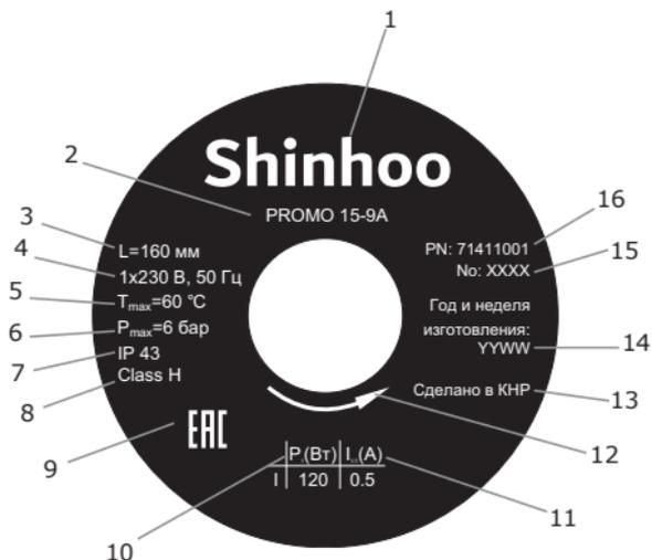
**Рис. 1** Пример фирменной таблички
