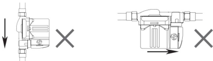
**Рис. 3** Недопустимое расположение вала насоса
