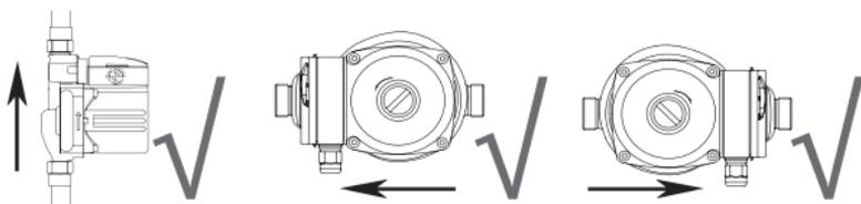
**Рис. 2** Допустимое расположение вала насоса
