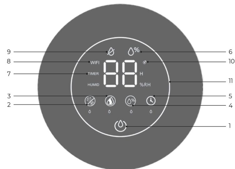
1. Кнопка ВКЛ/ВЫКЛ прибора
