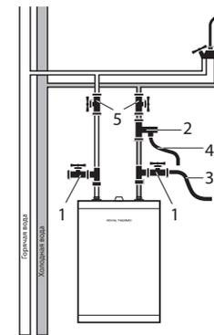
Рис. 5. Схема подключения к водопроводу моделей Novelty U
