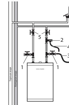
Рис. 5. Схема подключения к водопроводу моделей Novelty U
