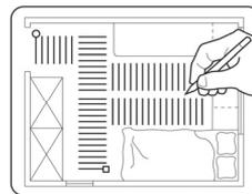
Рис. 4. Схема укладки нагревательного мата
