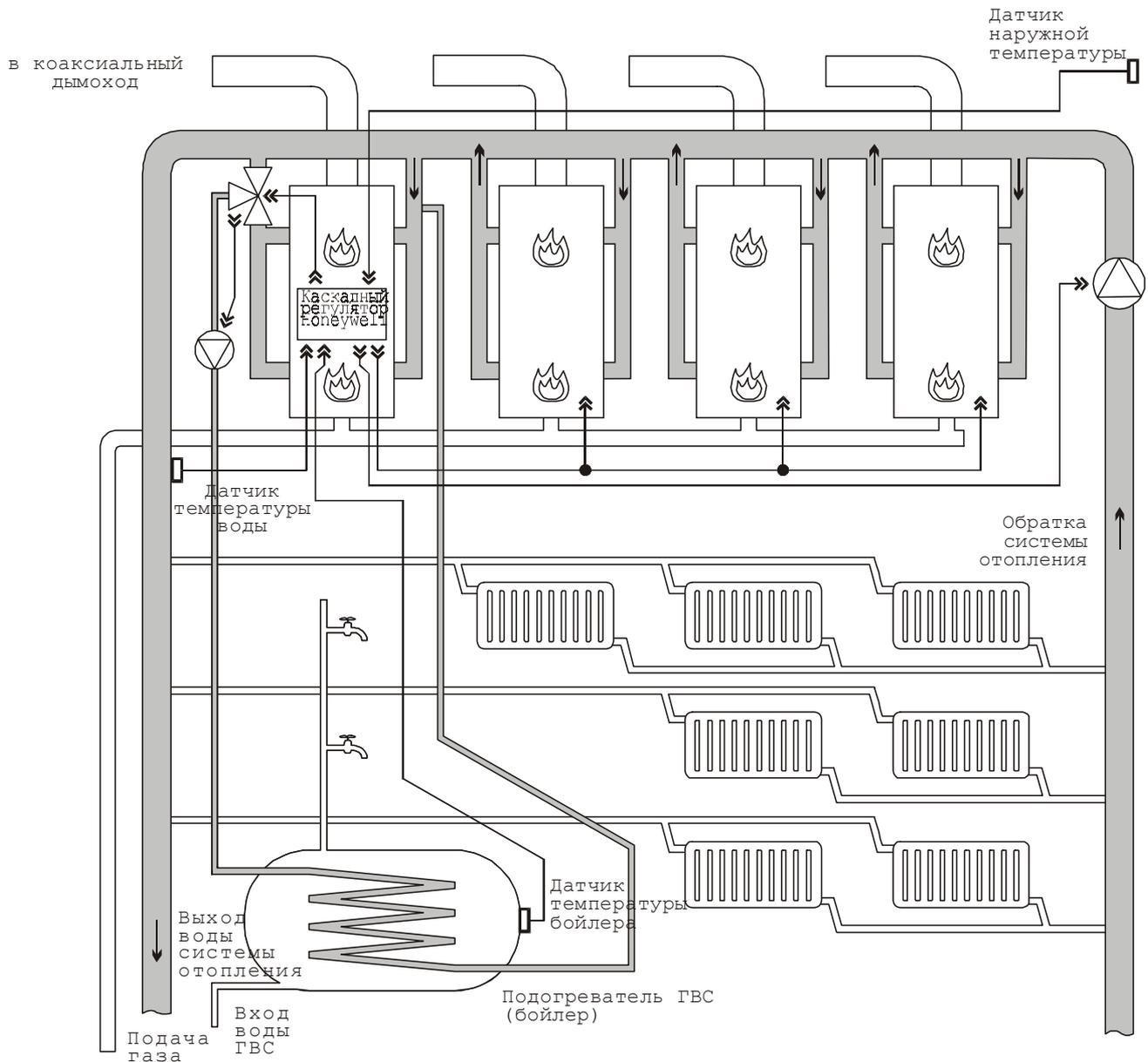
Рисунок 1- Схема системы теплоснабжения с котловыми модулями ПРОТЕРМ 50
