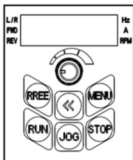
С помощью пульта пользователь может переключаться между двумя различными режимами работы: локальным и удаленным. Для выбора режима используется параметр P6-31.
