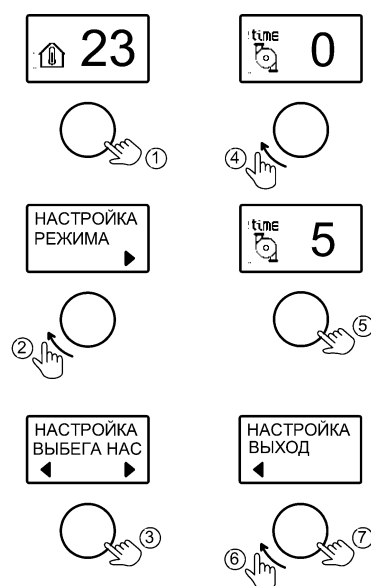
Рисунок 13. Настройка времени выбега насоса
