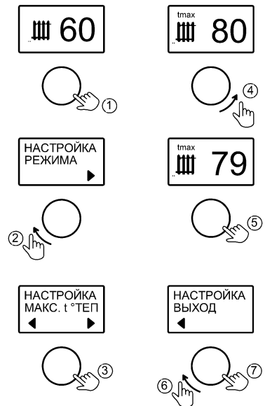
Рисунок 11. Настройка максимальной температуры теплоносителя
