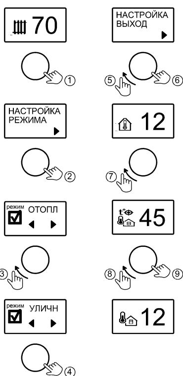
Рисунок 7. Выбор и настройка температуры
