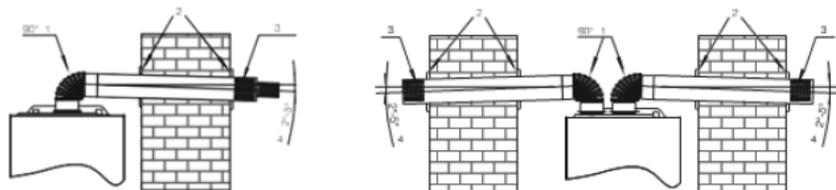
1 - 90° патрубков; 2 - фланец трубы дымохода; 3 - труба дымохода; 4 - уклон 2°-5°
