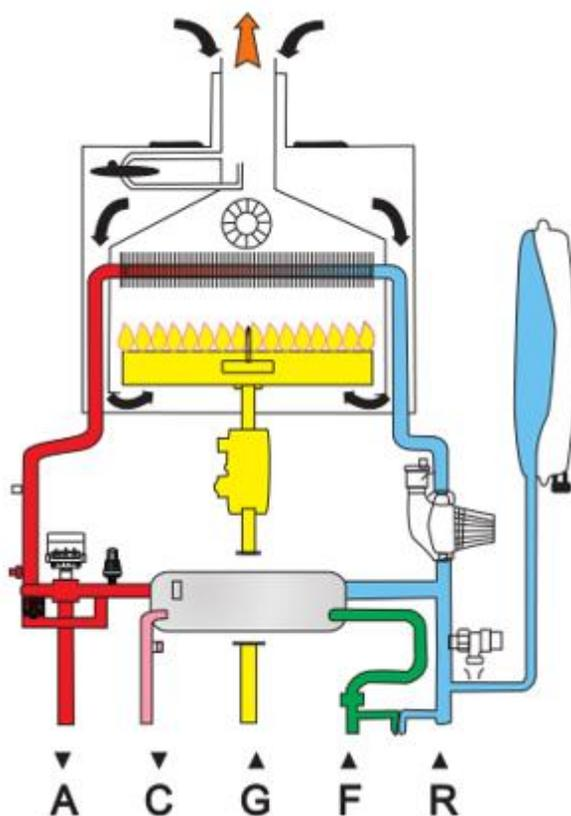
A- выход контура отопления
