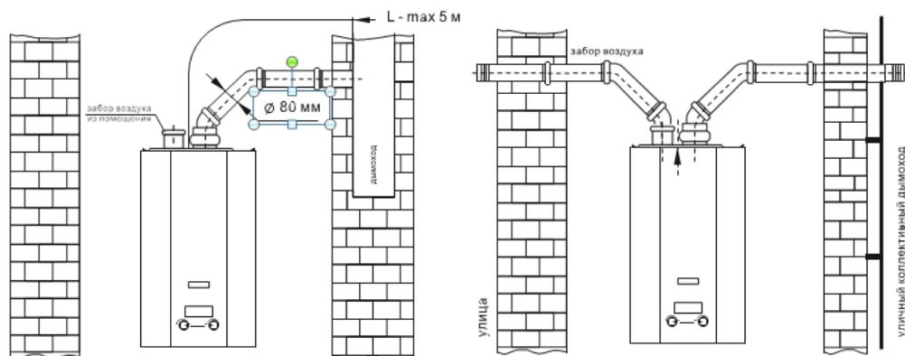
Котлы с закрытой камерой сгорания должны быть соединены с коаксиальными или отдельными дымоходами и воздуховодами, которые должны быть выведены наружу через крышу или наружную стену (См. рис. выше).
