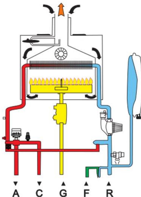
A- выход контура отопления
