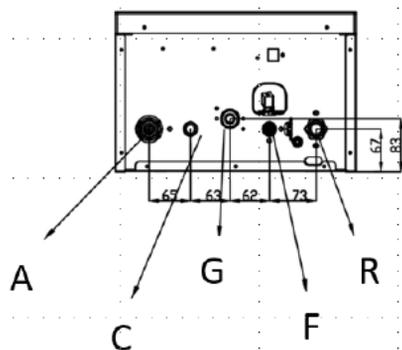
A- выход контура отопления G3/4
