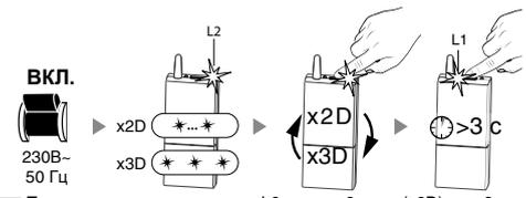
**RU** После включения индикатор L2 мигает 2 раза (x2D) или 3 раза (x3D). - Кратковременно нажать на кнопку для переключения между индикациями. - Подтвердить, нажав и удерживая нажатой в течение 3 с кнопку, пока не начнёт мигать индикатор L1. Отпустить кнопку. - Выполнить привязку радиопередатчика (см.руководство).
