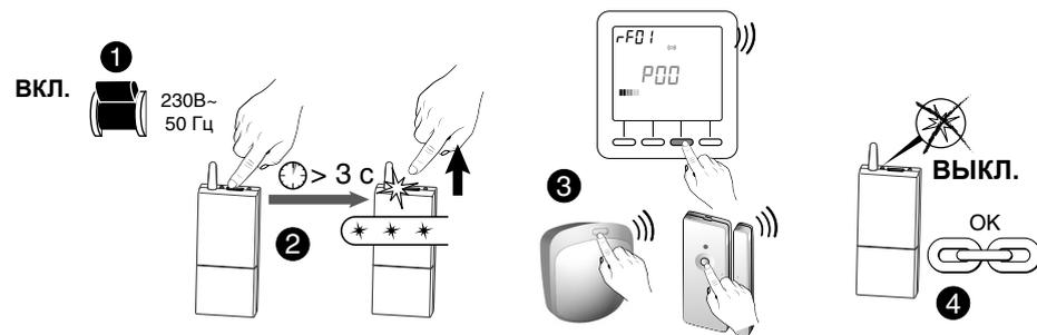
**RU** 1 Включить электропитание для установки. 2 Нажать и удерживать нажатой в течение 3 секунд кнопку радиопередатчика, пока его индикатор не начнёт мигать. Отпустить кнопку. 3 На термостате выполнить запрос на привязку по радиоканалу (см. руководство). 4 Проверить, что индикатор радиопередатчика больше не мигает. Привязка радиопередатчика и термостата успешно завершена.
