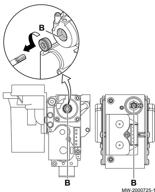
⇒ Значение содержания O<sub>2</sub> при минимальной мощности должно быть больше, чем значение содержания при максимальной мощности.
