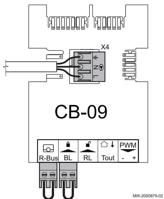
1. Подключить насос к клеммам **X4** электронной платы.
