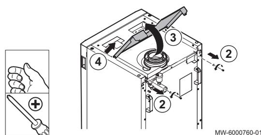
2. Вывернуть два винта из задней верхней панели котла.
