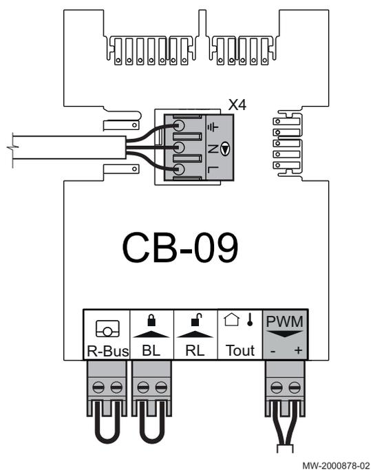
1. Подключить модулирующий насос к клеммам **X4** силовой секции и к клеммам **PWM** управляющей секции, учитывая полярность насоса.
