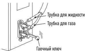
1. Используйте специальные трубы, предназначенные для холодильной техники. Не допускается использование загрязненных труб (с влагой и пылью).
