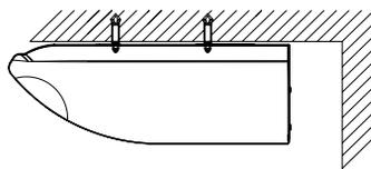
Для монтажа используйте болт с шайбами и пружинными шайбами.
