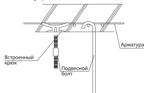
Рисунок 15 - Крепление подвесных болтов к основанию
