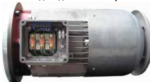
рис. G-4: Специальное подсоединение мотора
