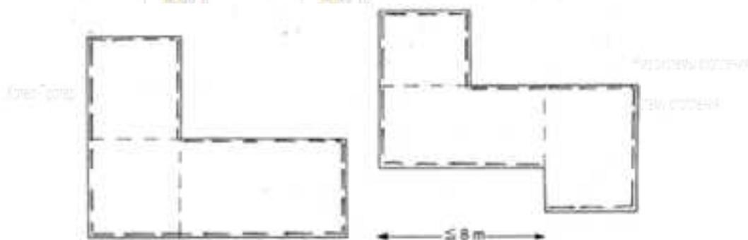
Рис 5.6. Устройство швов в конструкции пола
