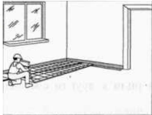
Рис 5.1 7. Раскладка теплоизолятора
