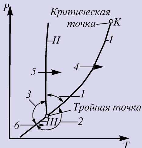
Рис. 1.2. Диаграмма равновесия фаз углекислоты; кривые: I — кипения, II — плавления, III — сублимации; 1 — жидкая фаза; 2 — газообразная; 3 — твердая; 4 — кипение; 5 — плавление; 6 — сублимация
