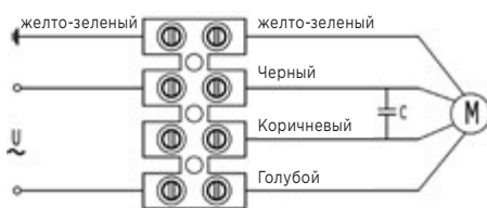
Схема № 1, 230 В, 1 ф
