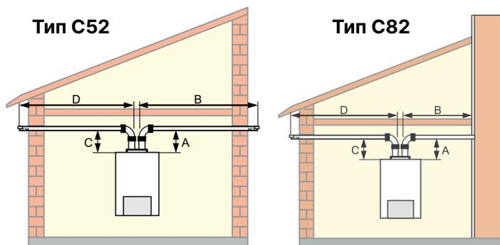
**C52** Соединение с дымоходом и подвод воздуха через наружную стену или крышу (забор воздуха для горения из атмосферы)
