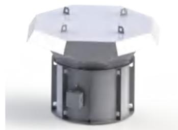
Вентилятор осевой крышный приточный на базе вентилятора осевого типа ВО-01-20; модификация вентилятора – 03 (с входным конфузуром и защитным колпаком); геометрический угол установки лопаток – 15°; номер 5; общего назначения из углеродистой стали; электродвигатель асинхронный  $N_y=1,1$  кВт; синхронная частота вращения рабочего колеса 3000 мин<sup>-1</sup>; умеренный климат 1-й категории размещения по ГОСТ 15150-69; номер технических условий на вентиляторы.
