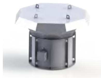
Вентилятор осевой крышный приточный на базе вентилятора осевого типа ВО-01-20; модификация вентилятора – 03 (с входным конфузуром и защитным колпаком); геометрический угол установки лопаток – 15°; номер 5; общего назначения из углеродистой стали; электродвигатель асинхронный  $N_y=1,1$  кВт; синхронная частота вращения рабочего колеса 3000 мин<sup>-1</sup>; умеренный климат 1-й категории размещения по ГОСТ 15150-69; номер технических условий на вентиляторы.
