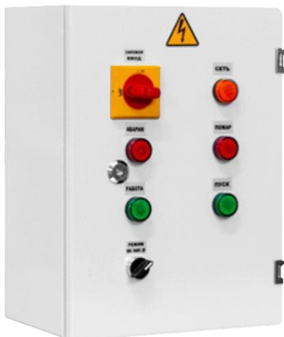
ШСАУ ПИОН построены на базе программируемых логических контроллеров. Шкафы моноблочного типа, совмещают автоматику и силовую часть - в одном корпусе размещаются силовые цепи, цепи защиты и распределения энергии по электроприёмникам, цепи управления и КИПиА.
