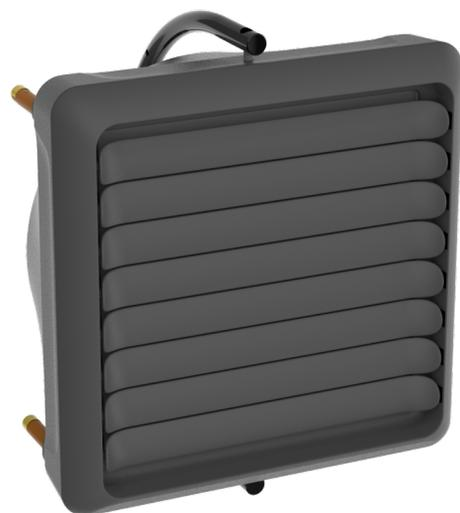
а) дестратификатор АВО-С3, расход воздуха 6500 м<sup>3</sup>/ч (0,76 кВт, 220/50, IP54) высота монтажа до 10 метров (при организации дополнительного распределительного сопла до 12 метров); б) дестратификатор на базе вентиляторов ОСА300АН..., расход воздуха 7216-15745 м<sup>3</sup>/ч (0,185-0,524 кВт, 220/50, IP54) высота монтажа до 30 метров.
