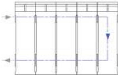
СХЕМА ДВИЖЕНИЯ ТЕПЛОНОСИТЕЛЯ ПРИ ПОДАЧЕ "СВЕРХУ-ВНИЗ"
