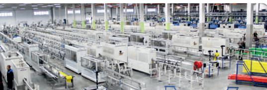
**4** 110 термопластавтоматами Haitian для производства фитингов для систем водоснабжения и отопления Ø20-110мм, фасонных частей для канализационных систем Ø32-160мм, компрессионных фитингов Ø20-63мм.
