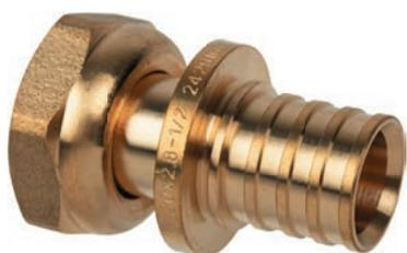
Фитинг из термообработанной латуни для соединения труб из сшитого полиэтилена USYSTEMS PE-Xa S3,2 (PN10) с отопительными и санитарными приборами, резьбовыми коллекторами, запорно-регулирующей арматурой и т.п. Соединение с трубой выполняется путём опрессовки подвижной гильзы с помощью комплекта расширительного и напрессовочного инструментов. Внутренняя резьба трубная цилиндрическая G по DIN EN ISO 228-1, ГОСТ 6357.
