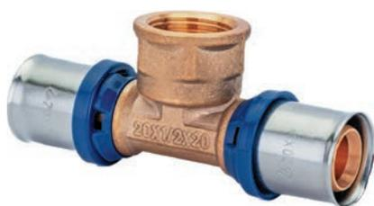
Изготавливается из латуни, с предустановленными пресс-гильзами из нержавеющей стали с контрольным отверстием и защищающим от контакта с алюминиевым слоем трубы кольцом. Не требуется снятие фаски благодаря уплотненным уплотнительным кольцам из EPDM. Имеет функцию защиты от протечки. Пластмассовые упорные кольца для позиционирования клещей инструмента профилей TH и U (26 мм – только TH).
