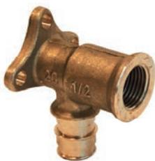
Фитинги из латуни для подключения труб из сшитого полиэтилена PE-Ха к санитарным приборам. Технология соединения трубы с фитингом основана на способности труб из сшитого полиэтилена восстанавливать свою первоначальную форму после расширения благодаря молекулярной памяти. Внутренняя резьба – трубная цилиндрическая G по DIN EN ISO 228-1, ГОСТ 6357.
