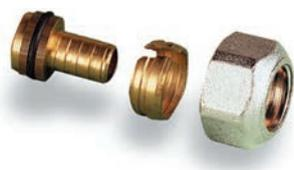
Изготавливается из покрытой латуни. Внутренняя резьба трубная цилиндрическая G1/2" по DIN EN ISO 228-1, ГОСТ 6357. Для присоединения труб PE-Xa 10 бар (S3,2) к радиаторным узлам и коллекторам с наружной резьбой 1/2" (конус).
