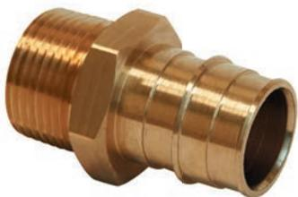
Фитинги из латуни для соединения труб из сшитого полиэтилена PE-Ха с отопительными и санитарными приборами, резьбовыми коллекторами, запорно-регулирующей арматурой и т.п. Технология соединения трубы с фитингом основана на способности труб из сшитого полиэтилена восстанавливать свою первоначальную форму после расширения благодаря молекулярной памяти.
