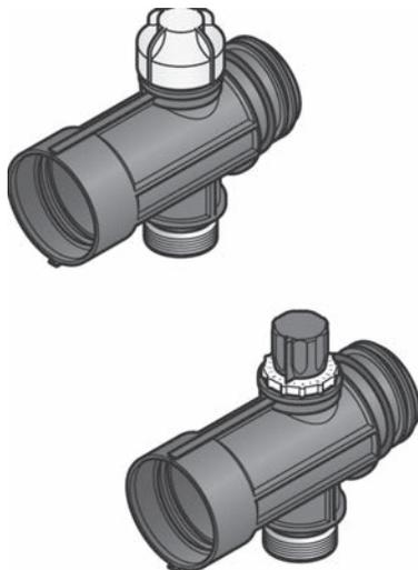
Промышленный коллектор диаметром 1 1/2" для напольного отопления больших площадей, а также систем снеготаяния. В комплект входят: подающий сегмент с балансировочным вентилем, имеющий одиночный выход 3/4"НР Евроконус;
