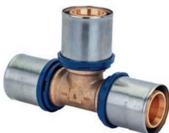
Изготавливается из латуни, с предустановленными пресс-гильзами из нержавеющей стали с контрольным отверстием и защищающим от контакта с алюминиевым слоем трубы кольцом. Пластмассовые упорные кольца для позиционирования клещей инструмента профилей TH и U.
