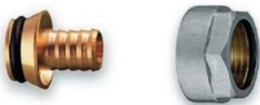
Изготавливается из покрытой латуни. Внутренняя резьба трубная цилиндрическая G3/4" Евроконус по DIN EN ISO 228-1, ГОСТ 6357. Для присоединения труб PE-Xa 6 бар (S5,0) и 10 бар (S3,2) к радиаторным узлам и коллекторам с наружной резьбой 3/4" Евроконус. См. возможную замену - USYSTEMS штуцер с накидной гайкой Евроконус латунный для труб PE-Xa (арт. 1136068 и арт. 1136069).
