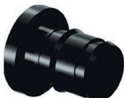
Полимерные фитинги из полифенилсульфона PPSU для соединения труб из сшитого полиэтилена PE-Ха. Технология соединения трубы с фитингом основана на способности труб из сшитого полиэтилена восстанавливать свою первоначальную форму после расширения благодаря молекулярной памяти. Фитинги универсальны для труб серий S5,0 и S3,2 (PN6 и PN10). Кольца для монтажа следует заказывать отдельно.
