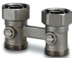
Узел для подключения к радиатору с нижней подводкой. Прямое исполнение, без байпаса. Имеет встроенные запорные краны. Подключение к радиатору – накидная гайка G3/4"НГ, подключение к трубам – наружная резьба G3/4"НР Евроконус для подключения зажимных адаптеров 3/4"BP Евроконус. Для подключения к радиаторам с внутренней резьбой 1/2"BP следует дополнительно использовать переходные ниппели G3/4"НР-G1/2"НР.
