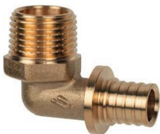
Фитинг из термообработанной латуни для соединения труб из сшитого полиэтилена USYSTEMS PE-Xa S3,2 (PN10) с отопительными и санитарными приборами, резьбовыми коллекторами, запорно-регулирующей арматурой и т.п. Соединение с трубой выполняется путём опрессовки подвижной гильзы с помощью комплекта расширительного и напрессовочного инструментов. Наружная резьба трубная коническая R по DIN EN 10226-1, ГОСТ 6211.
