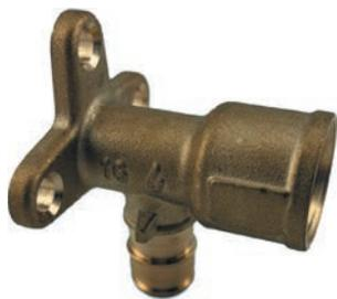
Фитинги из латуни для подключения труб из сшитого полиэтилена PE-Ха к санитарным приборам. Технология соединения трубы с фитингом основана на способности труб из сшитого полиэтилена восстанавливать свою первоначальную форму после расширения благодаря молекулярной памяти. Внутренняя резьба – трубная цилиндрическая Rp по DIN EN 10226-1, ГОСТ 6211.
