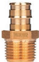
Фитинги из латуни для соединения труб из сшитого полиэтилена PE-Ха с отопительными и санитарными приборами, резьбовыми коллекторами, запорно-регулирующей арматурой и т.п. Технология соединения трубы с фитингом основана на способности труб из сшитого полиэтилена восстанавливать свою первоначальную форму после расширения благодаря молекулярной памяти.
