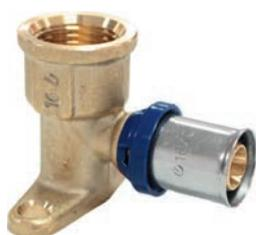
Изготавливается из латуни, с предустановленной пресс-гильзой из нержавеющей стали с контрольным отверстием и защищающим от контакта с алюминиевым слоем трубы кольцом. Не требуется снятие фаски благодаря уплотненным уплотнительным кольцам из EPDM. Имеет функцию защиты от протечки. Пластмассовое упорное кольцо для позиционирования клещей инструмента профилей TH и U. Внутренняя резьба трубная цилиндрическая Rp по DIN EN 10226-1, ГОСТ 6211.
