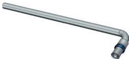
Изготавливается из латуни, с предустановленной пресс-гильзой из нержавеющей стали с контрольным отверстием и защищающим от контакта с алюминиевым слоем трубы кольцом. Не требуется снятие фаски благодаря уплотненным уплотнительным кольцам из EPDM. Имеет функцию защиты от протечки. Пластмассовое упорное кольцо для позиционирования клещей инструмента профилей TH и U. Подключение трубки 15 x 1 мм к радиаторному узлу 3/4"НР Евроконус необходимо выполнять зажимным адаптером Usystems (арт. 1136936).
