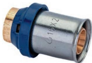
Изготавливается из латуни, с предустановленной пресс-гильзой из нержавеющей стали с контрольным отверстием и защищающим от контакта с алюминиевым слоем трубы кольцом. Не требуется снятие фаски благодаря уплотненным уплотнительным кольцам из EPDM. Имеет функцию защиты от протечки. Пластмассовое упорное кольцо для позиционирования клещей инструмента профилей TH и U.
