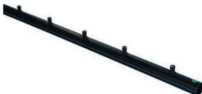
Коллектор для систем снеготаяния с ответвлениями 32 мм под полимерные трубы. Выполнен из полиэтилена высокой плотности (HDPE). Максимальная рабочая температура теплоносителя 50°C. Рабочее давление 4 бара. Муфты арт. 1136941 или арт. 1136045 для подключения полимерных труб 25 мм необходимо заказывать отдельно.
