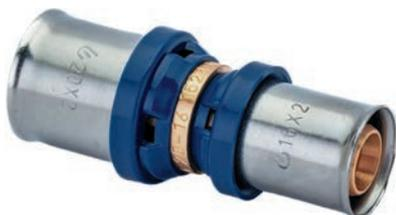
Изготавливается из латуни, с предустановленными пресс-гильзами из нержавеющей стали с контрольным отверстием и защищающим от контакта с алюминиевым слоем трубы кольцом. Не требуется снятие фаски благодаря уплотнительным кольцам из EPDM. Имеет функцию защиты от протечки. Пластмассовые упорные кольца для позиционирования клещей инструмента профилей TH и U (26 мм – только TH).
