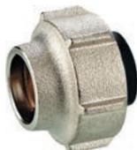
Для подключения медной/латунной трубки 15 x 1 мм тройников и уголков к радиаторным узлам 3/4"HP Евроконус. Внутренняя резьба 3/4"BP Евроконус. Состав: покрытая латунная гайка, встроенное латунное зажимное кольцо и уплотнительный конус из EPDM. Оребренная гайка под гаечный ключ 30.
