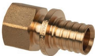
Фитинг из термообработанной латуни для соединения труб из сшитого полиэтилена USYSTEMS PE-Xa S3,2 (PN10) с отопительными и санитарными приборами, резьбовыми коллекторами, запорно-регулирующей арматурой и т.п. Соединение с трубой выполняется путём опрессовки подвижной гильзы с помощью комплекта расширительного и напрессовочного инструментов. Внутренняя резьба трубная цилиндрическая Rp по DIN EN 10226-1, ГОСТ 6211.
