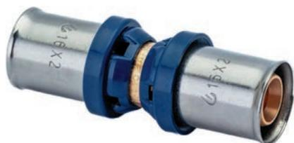
Изготавливается из латуни, с предустановленными пресс-гильзами из нержавеющей стали с контрольным отверстием и защищающим от контакта с алюминиевым слоем трубы кольцом. Не требуется снятие фаски благодаря уплотненным уплотнительным кольцам из EPDM. Имеет функцию защиты от протечки. Пластмассовые упорные кольца для позиционирования клещей инструмента профилей TH и U (26 мм – только TH).
