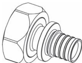
Фитинг из никелированной латуни для подключения труб из сшитого полиэтилена USYSTEMS PE-Xa S3,2 (PN10) к радиаторным узлам и коллекторам с наружной резьбой 3/4" Евроконус. Соединение с трубой выполняется путём опрессовки подвижной гильзы с помощью комплекта расширительного и напрессовочного инструментов. Внутренняя резьба трубная цилиндрическая G3/4" Евроконус по DIN EN ISO 228-1, ГОСТ 6357.
