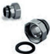
Переходной фитинг с плоским торцом, уплотнительным кольцом O-Ring со стороны соединения с наружной резьбой, укомплектован прокладкой из EPDM. Комплект – 2 шт. Для перехода с внутренней резьбы 1" на коллекторе на накидную гайку 1"НГ.
