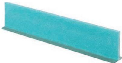
Состоит из самоклеящегося трака из ПЭТ и ленты из вспененного полиэтилена толщиной 10 мм, для установки в температурно-деформационных швах (например, дверных проёмах) и компенсации расширения стяжки.
