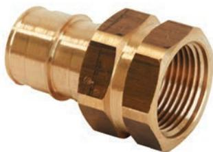
Фитинги из латуни для соединения труб из сшитого полиэтилена PE-Ха с отопительными и санитарными приборами, резьбовыми коллекторами, запорно-регулирующей арматурой и т.п. Технология соединения трубы с фитингом основана на способности труб из сшитого полиэтилена восстанавливать свою первоначальную форму после расширения благодаря молекулярной памяти. Внутренняя резьба – трубная цилиндрическая G по DIN EN ISO 228-1, ГОСТ 6357.
