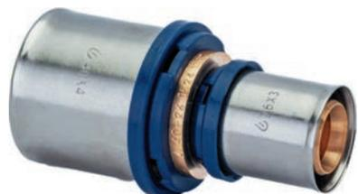
Изготавливается из латуни, с предустановленными пресс-гильзами из нержавеющей стали с контрольным отверстием и защищающим от контакта с алюминиевым слоем трубы кольцом. Пластмассовые упорные кольца для позиционирования клещей инструмента профилей TH и U (26 мм – только TH).
