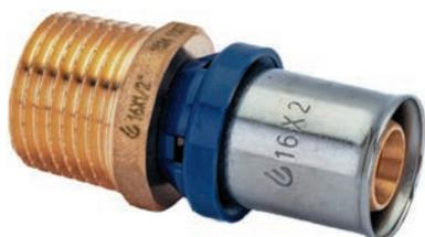
Изготавливается из латуни, с предустановленной пресс-гильзой из нержавеющей стали с контрольным отверстием и защищающим от контакта с алюминиевым слоем трубы кольцом. Не требуется снятие фаски благодаря уплотненным уплотнительным кольцам из EPDM. Имеет функцию защиты от протечки. Пластмассовое упорное кольцо для позиционирования клещей инструмента профилей TH и U (26 мм – только TH). Наружная резьба трубная коническая R по DIN EN 10226-1, ГОСТ 6211.
