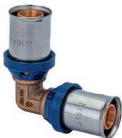
Изготавливается из латуни, с предустановленными пресс-гильзами из нержавеющей стали с контрольным отверстием и защищающим от контакта с алюминиевым слоем трубы кольцом. Не требуется снятие фаски благодаря уплотненным уплотнительным кольцам из EPDM. Имеет функцию защиты от протечки. Пластмассовые упорные кольца для позиционирования клещей инструмента профилей TH и U (26 мм – только TH).
