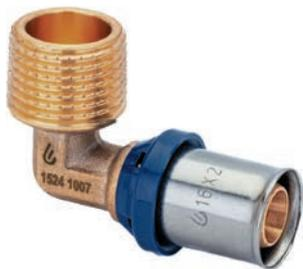
Изготавливается из латуни, с предустановленной пресс-гильзой из нержавеющей стали с контрольным отверстием и защищающим от контакта с алюминиевым слоем трубы кольцом. Не требуется снятие фаски благодаря уплотненным уплотнительным кольцам из EPDM. Имеет функцию защиты от протечки. Пластмассовое упорное кольцо для позиционирования клещей инструмента профилей TH и U. Наружная резьба трубная коническая R по DIN EN 10226-1, ГОСТ 6211.
