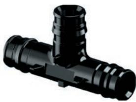
Полимерные фитинги из полифенилсульфона PPSU для соединения труб из сшитого полиэтилена PE-Ха. Технология соединения трубы с фитингом основана на способности труб из сшитого полиэтилена восстанавливать свою первоначальную форму после расширения благодаря молекулярной памяти. Фитинги универсальны для труб серий S5,0 и S3,2 (PN6 и PN10). Кольца для монтажа следует заказывать отдельно.
