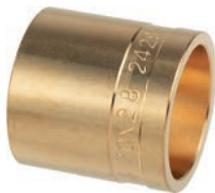
Гильза из термообработанной латуни, используется для монтажа соединений труб из сшитого полиэтилена PE-Xa S3,2 (PN10) с аксиальными фитингами USYSTEMS с помощью комплекта инструментов посредством подвижной опрессовки на фитинг после расширения трубы. Монтаж необходимо выполнять направлением внутренней фаски гильзы в сторону соединения.
