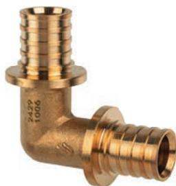
Фитинг из термообработанной латуни для соединения труб из сшитого полиэтилена USYSTEMS PE-Xa S3,2 (PN10) путём опрессовки подвижной гильзы. Монтаж с помощью комплекта расширительного и напрессовочного инструментов.
