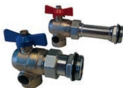
Изготавливается из покрытой латуни. Угловое исполнение. Наружная резьба 1"НР, внутренняя резьба 3/4"ВР. Наружная резьба со встроенной торцевой уплотнительной прокладкой под плоское уплотнение. Длина 94/142 мм. В комплект входят два крана.
