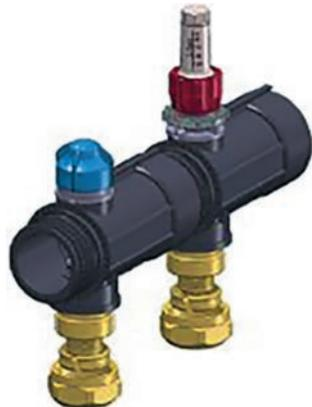
Промышленный коллектор диаметром 1 1/2" для напольного отопления больших площадей, а также систем снеготаяния. В комплект входят: подающий сегмент с расходомером, имеющий одиночный выход на петлю и оснащенный зажимным адаптером для подключения полимерной трубы 25x2,3 мм;
