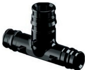
Полимерные фитинги из полифенилсульфона PPSU для соединения труб из сшитого полиэтилена PE-Xa. Технология соединения трубы с фитингом основана на способности труб из сшитого полиэтилена восстанавливать свою первоначальную форму после расширения благодаря молекулярной памяти. Фитинги универсальны для труб серий S5,0 и S3,2 (PN6 и PN10). Кольца для монтажа следует заказывать отдельно.
