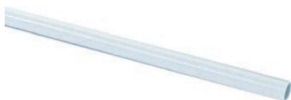
Кислородонепроницаемая металлополимерная композиционная труба (Полиэтилен повышенной термостойкости PERT II – Клей – Продольно сваренный встык алюминий – Клей – Полиэтилен повышенной термостойкости PE-RT II), для водоснабжения, радиаторного и напольного отопления, охлаждения.
