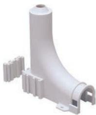
Изготавливается из пластика. Для фиксации загиба труб РЕ-Ха диаметром 16 мм при подключении к радиатору. Разборный, для кожуха 25/20 мм. Минимальное межосевое расстояние между трубами при использовании двух фиксаторов – 50. В комплект входит один фиксатор.
