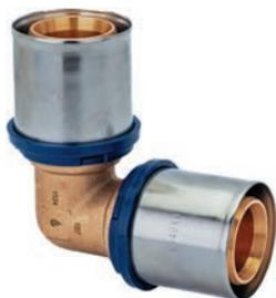
Изготавливается из латуни, с предустановленными пресс-гильзами из нержавеющей стали с контрольным отверстием и защищающим от контакта с алюминиевым слоем трубы кольцом. Пластмассовые упорные кольца для позиционирования клещей инструмента профилей TH и U.
