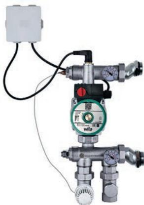
Насосно-смесительный блок в комплекте с термостатической головкой для поддержания постоянной температуры на подаче в системе напольного, настенного и потолочного отопления. Для арт. 1135960 насос следует приобретать отдельно: монтажная длина – 130 мм, насос с наружной резьбой 1 1/2" НР.
