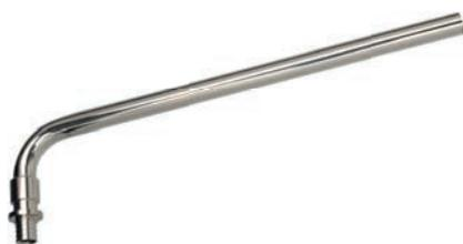
Для подключения труб из сшитого полиэтилена USYSTEMS PE-Xa S3,2 (PN10) к отопительным приборам. Изготавливается из латунной трубки 15 x 1 мм длиной 300 мм. Подключение трубки 15 x 1 мм к радиаторному узлу 3/4"BP Евроконус необходимо выполнять резьбовым адаптером 15CU. Соединение с трубой выполняется путём опрессовки подвижной гильзы с помощью комплекта расширительного и напрессовочного инструментов.
