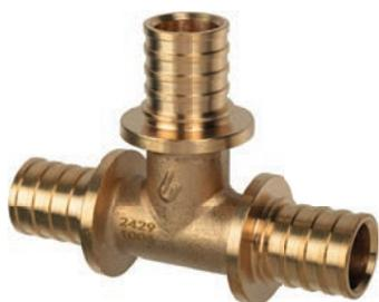
Фитинг из термообработанной латуни для соединения труб из сшитого полиэтилена USYSTEMS PE-Xa S3,2 (PN10) путём опрессовки подвижной гильзы. Монтаж с помощью комплекта расширительного и напрессовочного инструментов.
