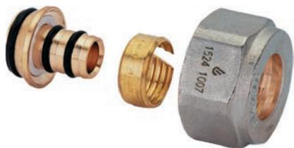
Зажимной адаптер, состоит из штуцера, обжимного кольца и гайки из латуни. Для подключения труб Usystems MLC к коллекторам и радиаторным узлам с наружной резьбой 3/4"НР Евроконус. Внутренняя резьба трубная цилиндрическая G по EN ISO 228-1, ГОСТ 6357. Перед монтажом необходимо снять фаску и откалибровать трубу.
