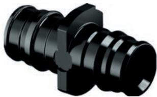
Полимерные фитинги из полифенилсульфона PPSU для соединения труб из сшитого полиэтилена PE-Ха. Технология соединения трубы с фитингом основана на способности труб из сшитого полиэтилена восстанавливать свою первоначальную форму после расширения благодаря молекулярной памяти. Фитинги универсальны для труб серий S5,0 и S3,2 (PN6 и PN10). Кольца для монтажа следует заказывать отдельно.
