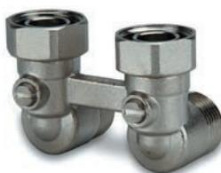
Узел для подключения к радиатору с нижней подводкой. Угловое исполнение, без байпаса. Имеет встроенные запорные краны. Подключение к радиатору – накидная гайка G3/4"НГ, подключение к трубам – наружная резьба G3/4"НР Евроконус для подключения зажимных адаптеров 3/4"BP Евроконус. Для подключения к радиаторам с внутренней резьбой 1/2"BP следует дополнительно использовать переходные ниппели G3/4"НР-G1/2"НР.
