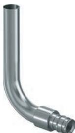
Изготавливается из латунной трубки 15 x 1 мм длиной 300-1000 мм. Подключение трубки 15 x 1 мм к радиаторному узлу 3/4"BP Евроконус необходимо выполнять резьбовым адаптером 15CU. Технология соединения трубы с фитингом основана на способности труб из сшитого полиэтилена восстанавливать свою первоначальную форму после расширения благодаря молекулярной памяти. Кольцо следует заказывать отдельно.
