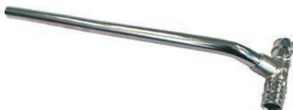
Изготавливается из латунной трубки 15 x 1 мм длиной 300 мм. Подключение трубки 15 x 1 мм к радиаторному узлу 3/4"BP Евроконус необходимо выполнять резьбовым адаптером 15CU. Технология соединения трубы с фитингом основана на способности труб из сшитого полиэтилена восстанавливать свою первоначальную форму после расширения благодаря молекулярной памяти. Кольцо следует заказывать отдельно.
