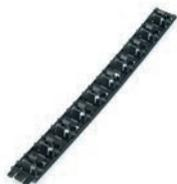
U-образная планка из полипропилена для крепления полимерных труб Usystems 16-20 мм. Жёстко крепится к рабочей поверхности, например, анкерами. Межосевое расстояние между фиксаторами 50 мм, длина трака 0,5 м. Отдельные траки стыкуются между собой с помощью защёлки.
