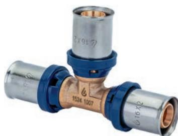
Изготавливается из латуни, с предустановленными пресс-гильзами из нержавеющей стали с контрольным отверстием и защищающим от контакта с алюминиевым слоем трубы кольцом. Не требуется снятие фаски благодаря уплотненным уплотнительным кольцам из EPDM. Имеет функцию защиты от протечки. Пластмассовые упорные кольца для позиционирования клещей инструмента профилей TH и U (26 мм – только TH).
