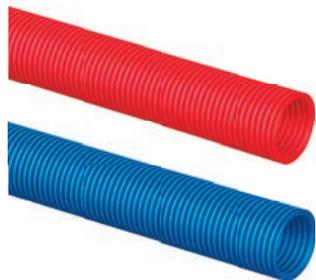
Защитный гофрированный кожух повышенной прочности. Изготавливается из полиэтилена высокой плотности (ПЭВП). Используется при прокладке труб по принципу «труба в трубе» для защиты трубы от механических повреждений, уменьшения ущерба от протечек, а также для возможности замены трубы. Тип: тяжёлый.
