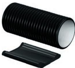
Для устройства прохода теплоизолированных труб через фундамент в местах, где отсутствует давление грунтовых вод. Набор состоит из проходной втулки длиной 550 мм, которая замуровывается в стене фундамента, термоусадочного рукава длиной 300 мм и ленты из термоактивируемого адгезива длиной 3 м.
