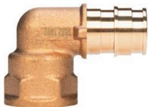
Фитинги из латуни для соединения труб из сшитого полиэтилена РЕ-Ха с отопительными и санитарными приборами, резьбовыми коллекторами, запорно-регулирующей арматурой и т.п. Технология соединения трубы с фитингом основана на способности труб из сшитого полиэтилена восстанавливать свою первоначальную форму после расширения благодаря молекулярной памяти. Внутренняя резьба – трубная цилиндрическая Rp по DIN EN 10226-1, ГОСТ 6211.
