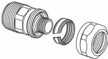
Зажимной фитинг стойкой к обесцинкованию латуни для соединения труб PE-Ха серии S3,2 (PN10). Фитинг Наружная резьба трубная коническая R по DIN EN 10226-1, ГОСТ 6211.
