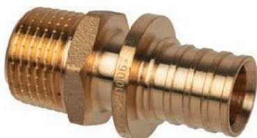
Фитинг из термообработанной латуни для соединения труб из сшитого полиэтилена USYSTEMS PE-Xa S3,2 (PN10) с отопительными и санитарными приборами, резьбовыми коллекторами, запорно-регулирующей арматурой и т.п. Соединение с трубой выполняется путём опрессовки подвижной гильзы с помощью комплекта расширительного и напрессовочного инструментов. Наружная резьба трубная коническая R по DIN EN 10226-1, ГОСТ 6211.
