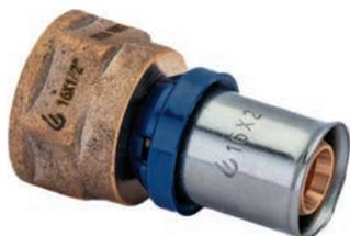
Изготавливается из латуни, с предустановленной пресс-гильзой из нержавеющей стали с контрольным отверстием и защищающим от контакта с алюминиевым слоем трубы кольцом. Не требуется снятие фаски благодаря утопленным уплотнительным кольцам из EPDM. Имеет функцию защиты от протечки. Пластмассовое упорное кольцо для позиционирования клещей инструмента профилей TH и U (26 мм – только TH). Внутренняя резьба трубная цилиндрическая Rp по DIN EN 10226-1, ГОСТ 6211.
