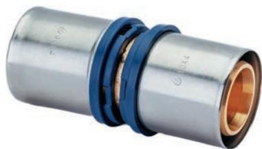
Изготавливается из латуни, с предустановленными пресс-гильзами из нержавеющей стали с контрольным отверстием и защищающим от контакта с алюминиевым слоем трубы кольцом. Пластмассовые упорные кольца для позиционирования клещей инструмента профилей TH и U.
