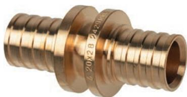
Фитинг из термообработанной латуни для соединения труб из сшитого полиэтилена USYSTEMS PE-Xa S3,2 (PN10) путём опрессовки подвижной гильзы. Монтаж с помощью комплекта расширительного и напрессовочного инструментов.
