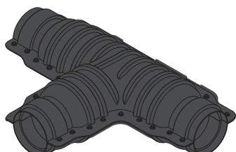
Комплекты для тепло- и гидроизоляции тройниковых соединений труб Thermo, Aqua, Varia – в исполнении Single и Twin, а также Supra Plus с кожухами 140, 175 и 200 мм. Комплект содержит изоляционный кожух, болты из нержавеющей стали, редукционные кольца, герметик. Фитинги для несущих труб в комплект не входят. Для труб Supra Plus следует дополнительно использовать комплект для кабеля (арт. 1136671). Использовать только совместно с термоусаживаемыми концевыми уплотнителями Usystems.
