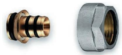
Изготавливается из покрытой латуни. Внутренняя резьба трубная цилиндрическая G3/4" Евроконус по DIN EN ISO 228-1, ГОСТ 6357. Для присоединения металлополимерных труб MLC к радиаторным узлам и коллекторам с наружной резьбой 3/4" Евроконус. Перед монтажом необходимо снять фаску и откалибровать трубу.
