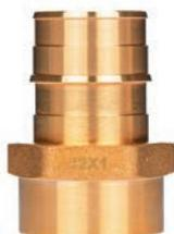
Фитинги из латуни для соединения труб из сшитого полиэтилена PE-Ха с отопительными и санитарными приборами, резьбовыми коллекторами, запорно-регулирующей арматурой и т.п. Технология соединения трубы с фитингом основана на способности труб из сшитого полиэтилена восстанавливать свою первоначальную форму после расширения благодаря молекулярной памяти. Внутренняя резьба – трубная цилиндрическая Rp по DIN EN 10226-1, ГОСТ 6211.
