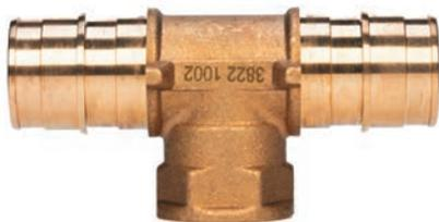
Фитинги из латуни для соединения труб из сшитого полиэтилена РЕ-Ха с отопительными и санитарными приборами, резьбовыми коллекторами, запорно-регулирующей арматурой и т.п. Технология соединения трубы с фитингом основана на способности труб из сшитого полиэтилена восстанавливать свою первоначальную форму после расширения благодаря молекулярной памяти. Внутренняя резьба – трубная цилиндрическая Rp по DIN EN 10226-1, ГОСТ 6211.
