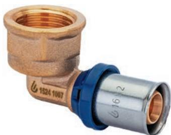
Изготавливается из латуни, с предустановленной пресс-гильзой из нержавеющей стали с контрольным отверстием и защищающим от контакта с алюминиевым слоем трубы кольцом. Не требуется снятие фаски благодаря уплотненным уплотнительным кольцам из EPDM. Имеет функцию защиты от протечки. Пластмассовое упорное кольцо для позиционирования клещей инструмента профилей TH и U. Внутренняя резьба трубная цилиндрическая Rp по DIN EN 10226-1, ГОСТ 6211.
