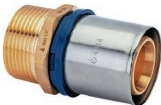
Изготавливается из латуни, с предустановленной пресс-гильзой из нержавеющей стали с контрольным отверстием и защищающим от контакта с алюминиевым слоем трубы кольцом. Пластмассовое упорное кольцо для позиционирования клещей инструмента профилей TH и U. Наружная резьба трубная коническая R по DIN EN 10226-1, ГОСТ 6211.
