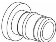
Фитинги из коррозионностойкой латуни для соединения труб из сшитого полиэтилена PE-Ха. Технология соединения трубы с фитингом основана на способности труб из сшитого полиэтилена восстанавливать свою первоначальную форму после расширения благодаря молекулярной памяти. Фитинги универсальны для труб серий S5,0 и S3,2 (PN6 и PN10). Кольца для монтажа следует заказывать отдельно.
