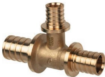
Фитинг из термообработанной латуни для соединения труб из сшитого полиэтилена USYSTEMS PE-Xa S3,2 (PN10) путём опрессовки подвижной гильзы. Монтаж с помощью комплекта расширительного и напрессовочного инструментов.
