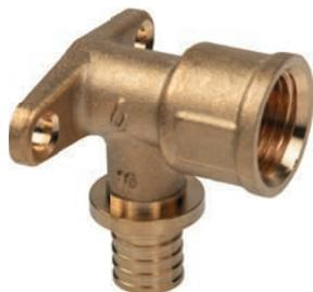
Фитинг из латуни для подключения труб из сшитого полиэтилена USYSTEMS PE-Xa S3,2 (PN10) к санитарным приборам. Соединение с трубой выполняется путём опрессовки подвижной гильзы с помощью комплекта расширительного и напрессовочного инструментов. Внутренняя резьба трубная цилиндрическая Rp по DIN EN 10226-1, ГОСТ 6211.
