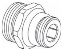
Изготавливается из покрытой латуни, с самоуплотнением. Предназначен для радиаторных узлов с внутренней резьбой 1/2"BP, служит переходом с внутренней резьбы 1/2"BP на наружную резьбу 3/4"HP Евроконус, совместим с резьбовыми адаптерами.
