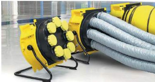
На комбинированном распределителе может применяться до 8-ми 100 мм-шлангов и при высокой центральной мощности кроме того один 450 мм-воздушный шланг. Для вентиляции на длинных дистанциях рекомендовано комбинированное применение мощных вентиляторов высокого давления TTV 4500 HP на 250 Па.
