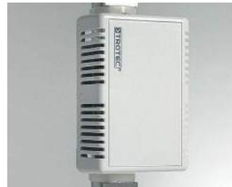
Таким способом, измеряемый прибор контролирует образование конденсата и при превышении посредством внутреннего микровыключателя предельного значения, автоматически регулирует связанные посредством подключаемых клемм, установок для осушки воздуха. Контроллер точки росы не требует напряжения питания и гибко применяется для труб диаметром до 50 мм.
