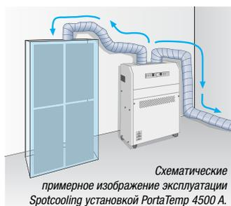
**Быстрая установка с помощью комплекта связующих элементов PortaTemp-W:**
