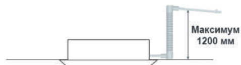
Мощность напора дренажного насоса — 1,2 м
