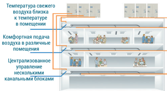
Многопоточная подача воздуха канальными блоками
