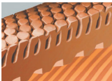
Структура трубок затопленного испарителя
