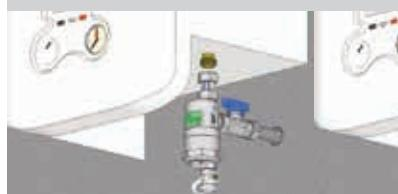
ПРИМЕР УСТАНОВКИ ГРЯЗЕУЛОВИТЕЛЯ COMPACTFAR С УГОЛЬНИКОМ (5304), ПОД НАСТЕННЫМ КОТЛОМ
