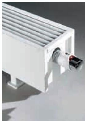
Благодаря небольшой высоте (всего 8, 13 или 23 см, в зависимости от модели) конвекторы Mini представляют собой идеальное решение при установке отопительного прибора под окнами с низким подоконником или для свободной установки прибора на полу возле таких окон. Создавая завесу теплового воздуха, Mini отсекает холодные потоки, идущие от окна или стены, и, таким образом, сводит к минимуму потери энергии. Изящный современный дизайн позволяет устанавливать Mini в любой интерьер.
