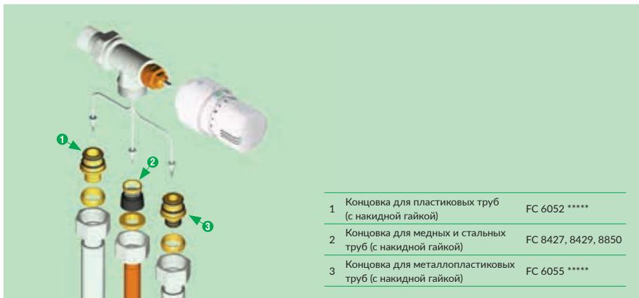
Присоединение к трубопроводу: резьба M24x19 для прямого присоединения металлопластиковых, пластиковых труб диаметром до 20 мм, медных труб – до 16 мм.
