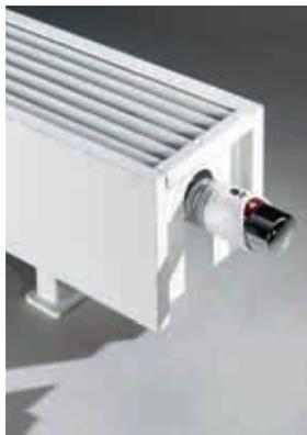
Благодаря небольшой высоте (всего 8, 13 или 23 см, в зависимости от модели) конвекторы Mini представляют собой идеальное решение при установке отопительного прибора под окнами с низким подоконником или для свободной установки прибора на полу возле таких окон. Создавая завесу теплого воздуха, Mini отсекает холодные потоки, идущие от окна или стены, и, таким образом, сводит к минимуму потери энергии. Изящный современный дизайн позволяет устанавливать Mini в любой интерьер.
