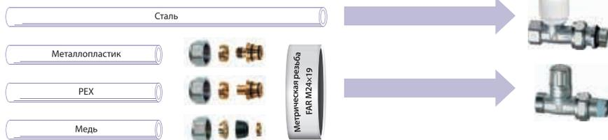
Присоединение к трубопроводу: резьба M24x19 для прямого присоединения металлопластиковых, пластиковых труб диаметром до 20 мм, медных труб – до 16 мм
