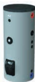
Материал бака – эмалированная сталь. В водонагревателях версии «STA 200/300 C (E) / C2(E)» установлен ТЭН мощностью 2,4 кВт. Магниевоый анод для защиты от коррозии. Фланец для инспекционного контроля. Наружное покрытие из цветного пластика – поливинилхлорид. Термометр. Модели с одним или двумя теплообменниками. 7 лет гарантии на резервуар.
