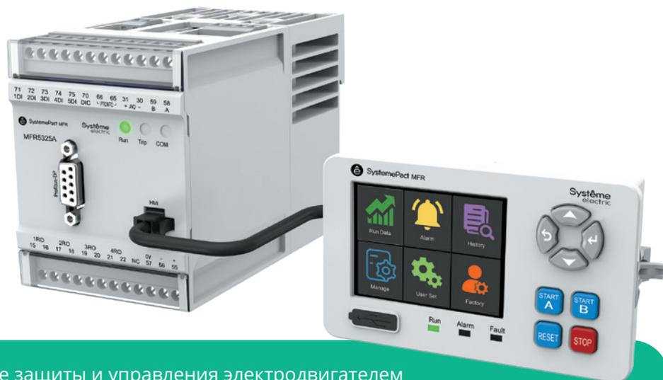
Многофункциональные реле защиты и управления электродвигателем серии MFR530 (далее – реле) используется с трехфазными двигателями, предназначенными для сетей переменного тока с частотой 50/60 Гц, номинальным напряжением до 690 В и номинальным током до 800 А.
