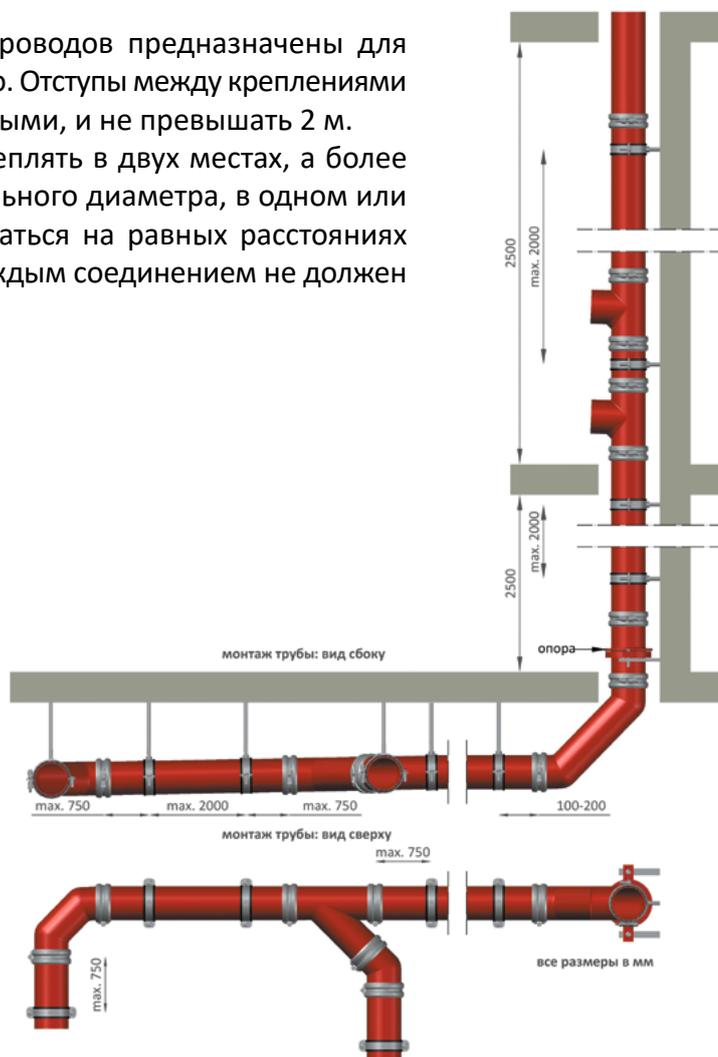
Общая схема монтажа системы Sanline SML
