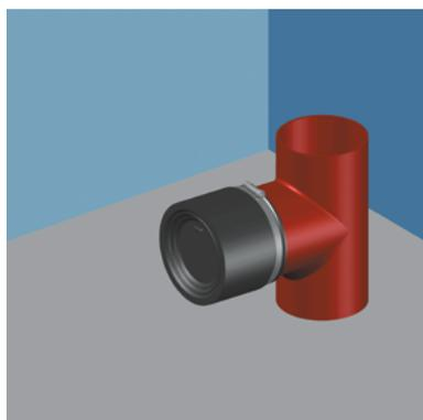
**1.** Ослабить стальной затяжной хомут и установить переходник на конце трубы до касания ею разделительного кольца.
