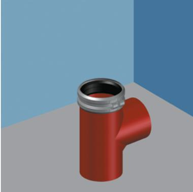
**1.** Соединительный хомут надеть на трубу (или фитинг) таким образом, чтобы конец трубы соприкасался с центральным отделяющим кольцом уплотнителя из EPDM.
