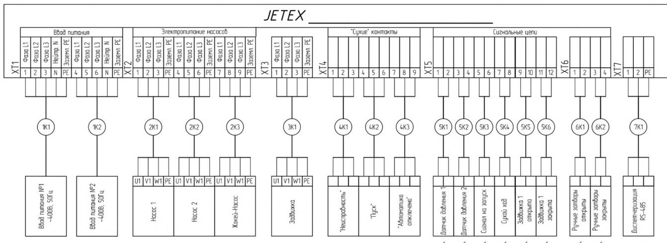
Двухнасосная станция пожаротушения с жокей насосом и возможностью управления одной электрозадвижкой
