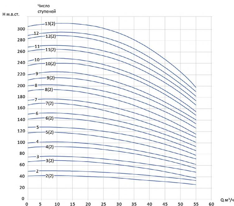
Шкала производительности насосной станции, исходя из количества рабочих агрегатов
