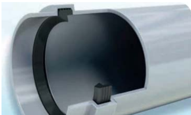
Рис. 8. Кольцо манжетного типа, используемое для уплотнения раструбных соединений труб и фасонных частей из полипропилена
