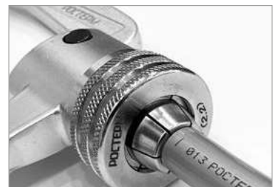
3. Проведите экспандирование трубы PE-X в три этапа (30%, 70%, 100%), между этапами проворачивая экспандируемую трубу на 30° вокруг своей оси.
