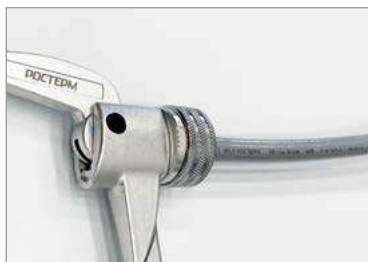
2. Вставьте наконечник насадки в трубу PE-X.
