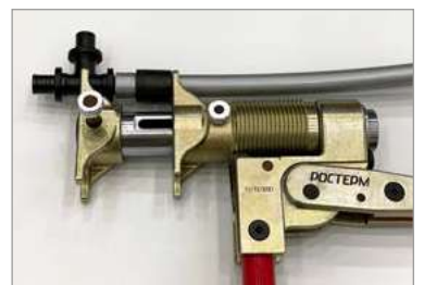
6. Вставьте фитинг в зажимной инструмент.
