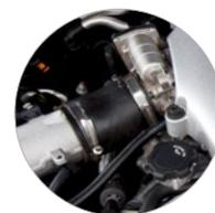
Асимметричный корпус обеспечивает высокое усилие, превосходный момент затяжки и равномерное распределение усилия зажима. Хомут идеально располагается на шланге и обеспечивает оптимальное уплотнение соединения.
