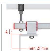
Увеличенная зона (A) для крепления шпильки. Нет ограничения перемещения подвижной части опоры при установке на широкое основание.
