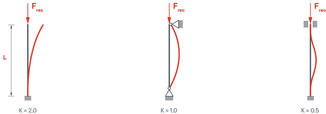
Допустимые нагрузки при продольном изгибе
