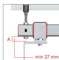
Увеличенная зона (A) для крепления шпильки. Нет ограничения перемещения подвижной части опоры при установки на широкое основание.
