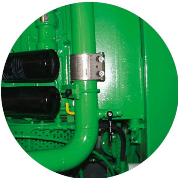
Трубные муфты FGR представляют собой компактное, экономичное и надежное средство для соединения труб с гладкими концами. Они подходят для соединения пластиковых и металлических труб, особенно труб из нержавеющей стали. Они могут применяться в машиностроении и строительстве, судостроении, гражданском строительстве, гидротехнике, водоснабжении и водоочистке.
