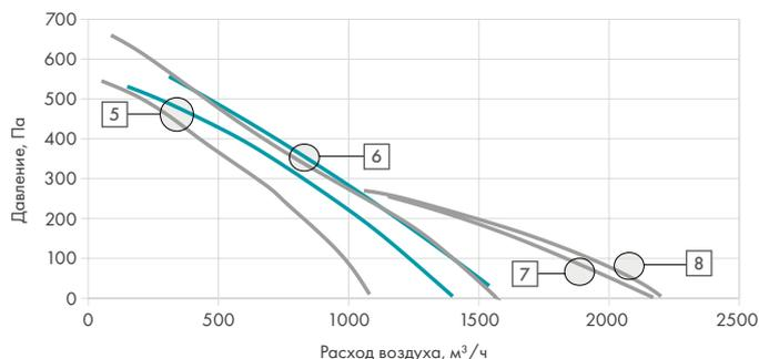
— p Стандарт, пластиковый корпус      — m Стандарт, стальной корпус
