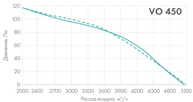
\*Графики на однофазные и трехфазные вентиляторы совпадают
