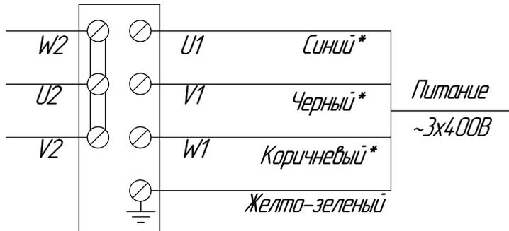
*Схема соединения обмоток двигателя «Звезда»*
