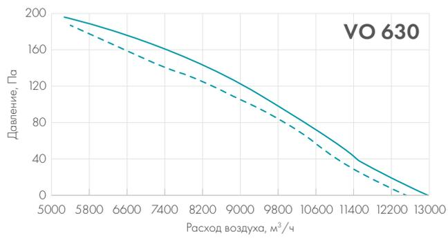
\*Графики на однофазные и трехфазные вентиляторы совпадают
