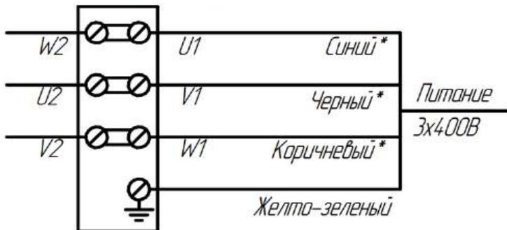
*Схема соединения обмоток двигателя «Треугольник»*
