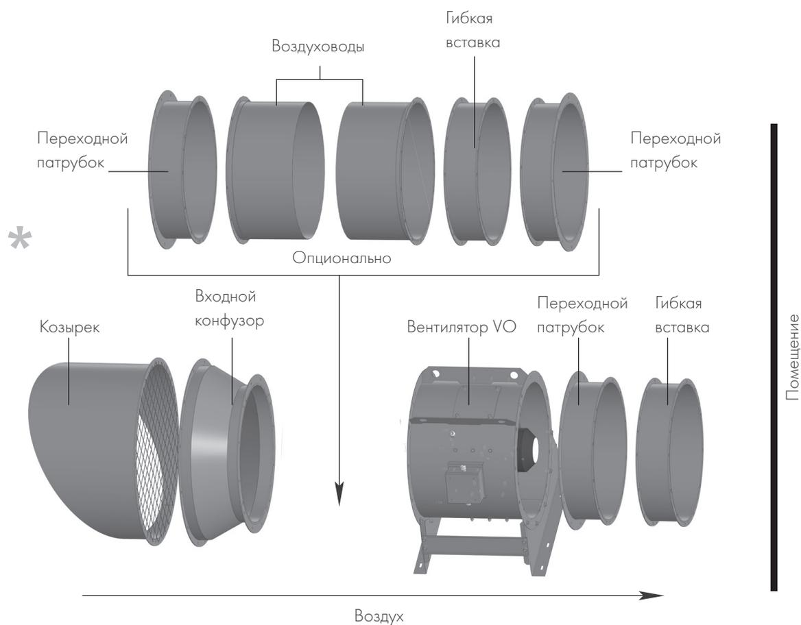
\* Систему воздуховодов добавляют опционально при необходимости. В этом случае рекомендуют применять гибкую вставку и два присоединительных патрубка
