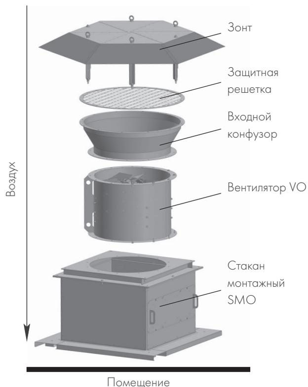
**СХЕМА 2: ВЕРТИКАЛЬНЫЙ НА ВЫТЯЖКУ**
