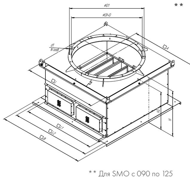
Основные размеры монтажных стаканов с клапаном противопожарным
