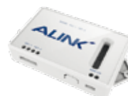
Шлюз для подключения к системе диспетчеризации
