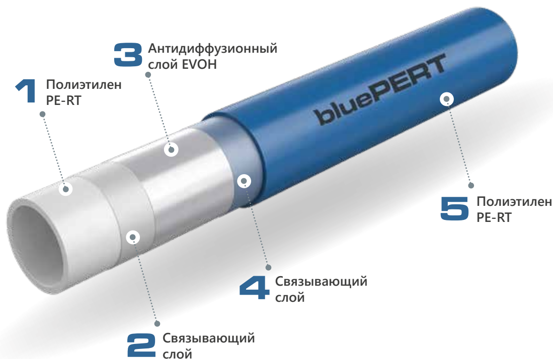
Рис. 45. Конструкция труб bluePERT со слоем EVOH
