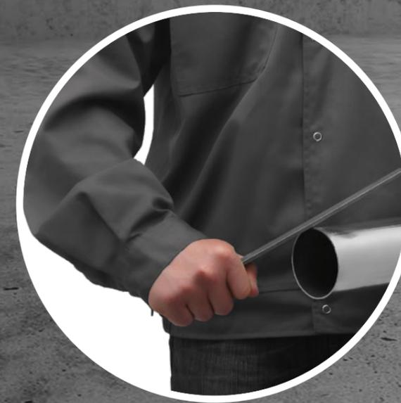
**02** | Снятие фаски с наружной и внутренней поверхности отрезанного конца трубы с помощью специальных фаскоснимателей для труб (для диаметров до 54 мм включительно) или полукруглых напильников для стали (для диаметров свыше 54 мм).
