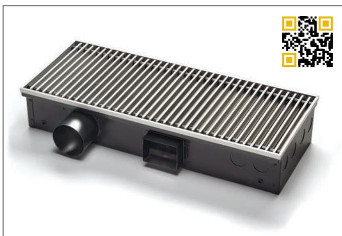
Гольфстрим КПК – внутрипольный конвектор с подводом приточного воздуха от системы вентиляции. За счет своего принципа действия, помимо обогрева, прибор также обеспечивает приток свежего воздуха в помещение. Его подача на теплообменник конвектора регулируется шиберной заслонкой.
