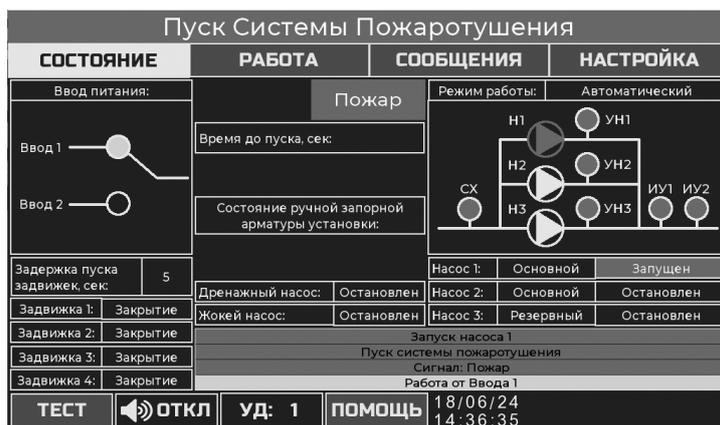
Рис. 12 Вид меню «Состояние» при поступлении сигнала на запуск
