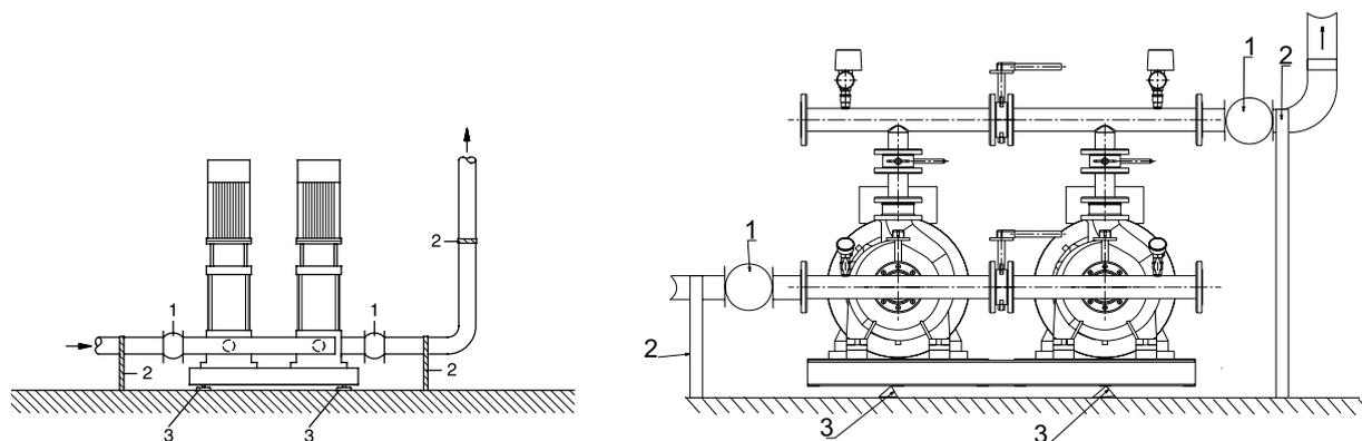
Рис. 5 Пример монтажа виброкомпенсаторов (1), виброизолирующих опор (3) и опор крепления труб (2).
