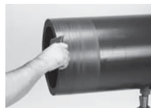
Фото 2.2. Снятие фаски для облегчения надевания муфты
